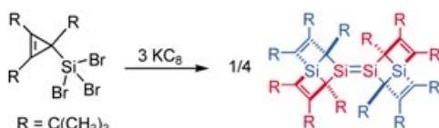
**Sperrige Schutzgruppen:** Eine Eintopfreduktion von Tri(tert-butyl)cyclopropenyl-tribromosilane mit Kaliumgraphit ergab ein einzigartiges Gitternetz-Disilene in 47% Ausbeute (siehe Schema). Das neue
